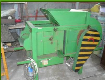
Szelel rosta, a száraz magtételt befelvez tisztításához.
