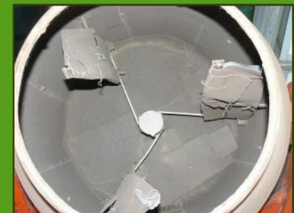
Csiszolópapírral bélelt keverőgép, a koptatás eszköze.
